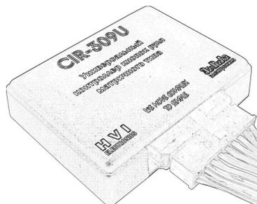
*Функциональное назначение:* CIR-309U служит интерфейсом между резистивной матрицей кнопок руля автомобиля и командами, которые должно выполнять внешнее устройство под их управлением. Кроме этого, устройство имеет цифровой вход данных, благодаря которому, команды управления можно передавать от любого другого совместимого устройства, например, декодера CAN шины.
